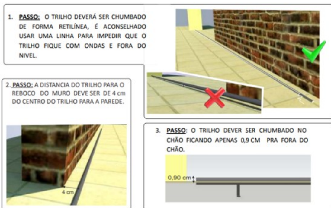
Figura 11: Detalhamento de execução dos trilhos do portão de correr.
